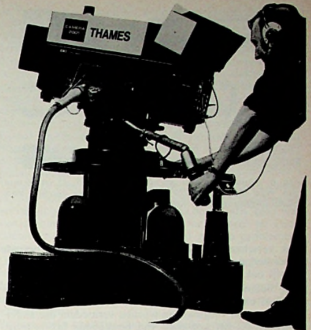
Afb. 5: KTV-camera met vier opneembuizen EMI type 2001 met gescheiden luminantie.
