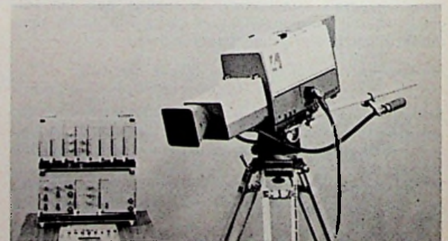
Afb. 4: Fernseh-KTV-camera KCU-40 samen met de Tele-control-geheugen eenheid.
