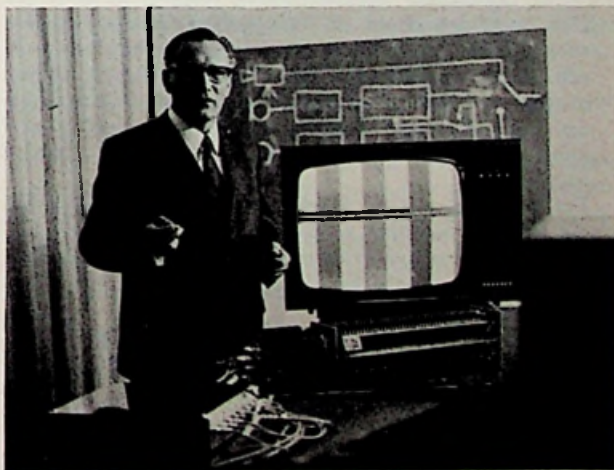
Afb. 1. De ontwerper van het COM-systeem, de heer Gassmann van SEL, bij de laboratoriumopstelling tijdens een demonstratie. Op de voorgrond is het geheugen duidelijk zichtbaar. Om experimentele redenen werd dit geheugen uit zeer vele halfgeleiders samengesteld, zodat de hoeveelheid materiaal en de afmetingen van dit proefmodel bepaald niet representatief zijn voor hetgeen uiteindelijk met geïntegreerde technieken kan worden bereikt.
