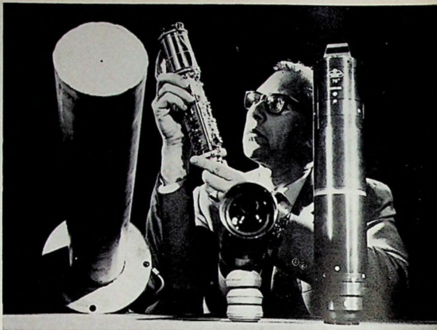
Afb. 4. TV-beelden uit een smeltoven. Deze televisie opneembuis (midden) van Siemens wordt ingezet op vrijwel ontoegankelijke plaatsen waar de temperatuur hoog ligt, zoals b.v. in stoomketels, kernreactoren, gloeiovens e.d. Met de zgn. sonden-optiek (midden rechts op tafel) samengebouwd verkrijgen we de camera (rechtsstaande); terwijl deze op zijn beurt in een watergekoeld cilindrisch huis wordt ondergebracht. (Siemens).
